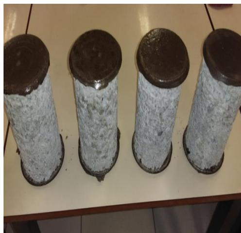
Figura 2 – Corpos de prova capeados com enxofre
