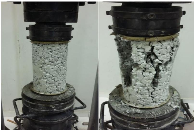
Figura 3 - Execução do ensaio de compressão dos corpos de prova cilíndricos
