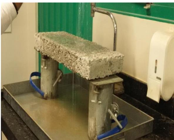
Figura 4 – Ensaio de permeabilidade
