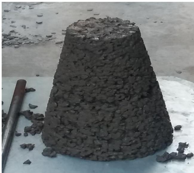
Figura 6 - Execução do *Slump test*
