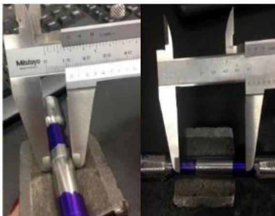
Figura 3 - Medição do corpo de prova com paquímetro.
