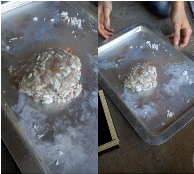
Figura 5. Processo de Mistura da cola com os grânulos de EVA.
