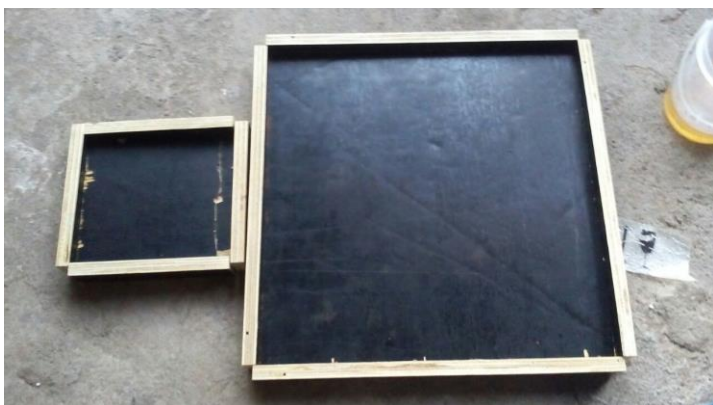
Figura 3. Formas utilizadas para moldar as placas.
