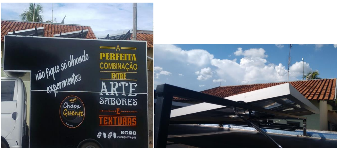
Figura 6 – Inclinação dos painéis solares
