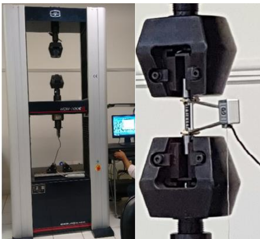
Figura 2: Ensaio de tração e deformação
