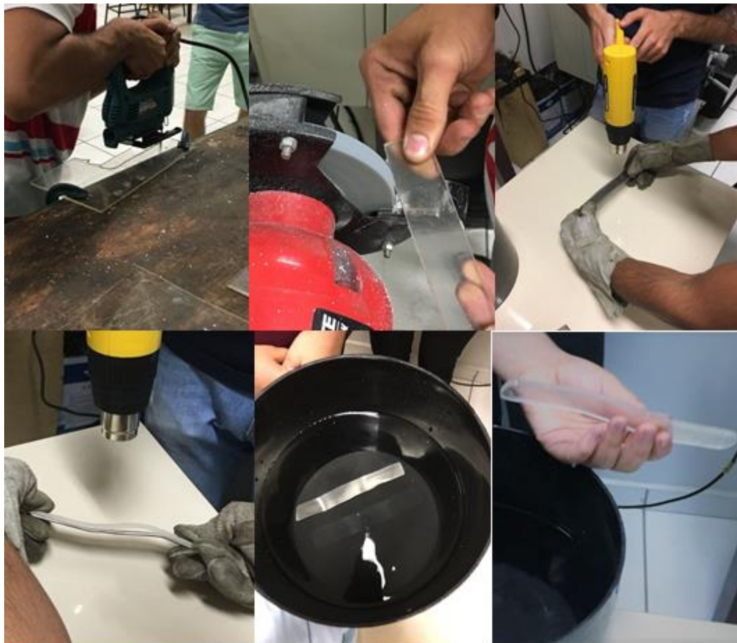
Figura 6: Processos de fabricação da tala ortopédica Fonte: Elaborada pelos autores (2017)
