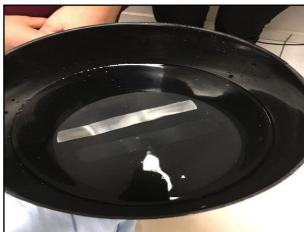
Figura 4: Choque térmico da chapa de acrílico Fonte: Elaborada pelos autores (2017).
