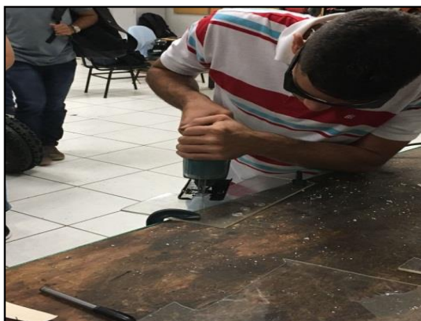
Figura 1: Cortar chapa de acrílico Fonte: Elaborada pelos autores (2017).
