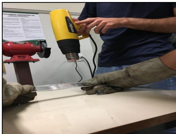
Figura 3: Aquecer chapa de acrílico Fonte: Elaborada pelos autores (2017).
