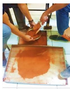
Figura 02: Solo passado na peneira nº 4 – fonte: próprio autor (2017).
