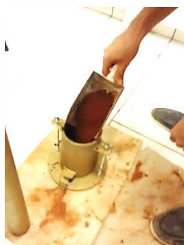
Figura 05: Solo sendo colocado no cilindro – fonte: próprio autor (2017).
