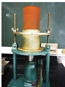
Figura 09: Extração do corpo de prova –
