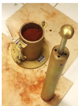
Figura 04: Cilindro montado e soquete – fonte: próprio autor (2017).
