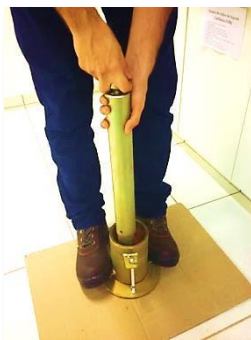
Figura 06: Solo sendo compactado com o soquete
