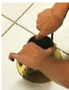
Figura 07: Solo sendo escarificado – fonte: próprio autor (2017).
