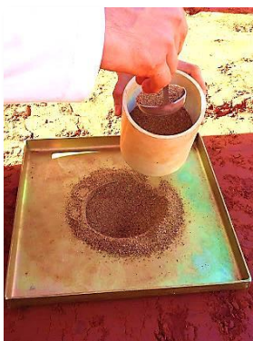
Figura 19: Retirada de areia do furo - fonte: próprio autor (2017).
