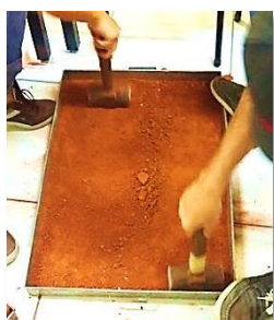
Figura 01: Solo sendo destorroado – fonte: próprio autor (2017).
