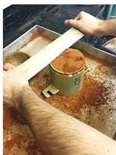
Figura 08: Nivelção do solo – fonte: próprio autor (2017).
