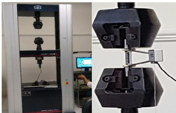
Figura 6 - Máquina Eletromecânica Universal WDW-100E III (SHINJIN)
