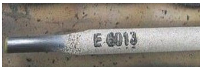
Figura 5 – Eletrodo revestido E 6013
