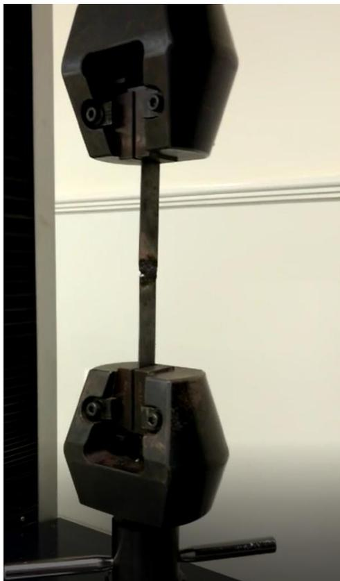
Figura 2 - Máquina de tração e corpo de prova do aço SAE 1008.
