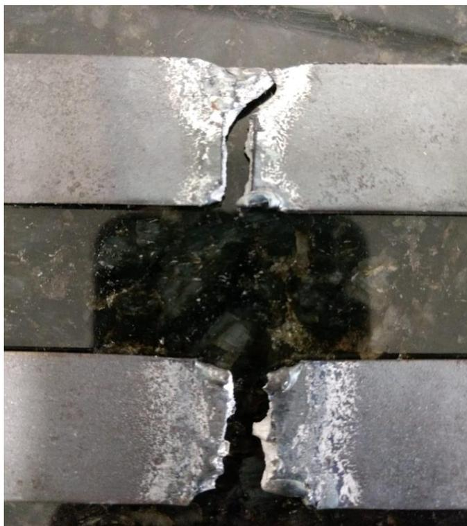
Figura 4 - Chapa chanfrada após sofrer o ensaio de tração
