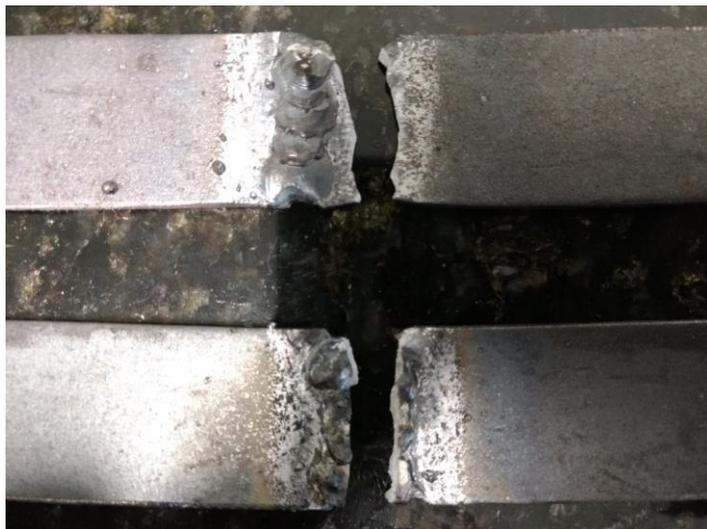
Figura 3 -Chapa reta após sofrer o ensaio de tração
