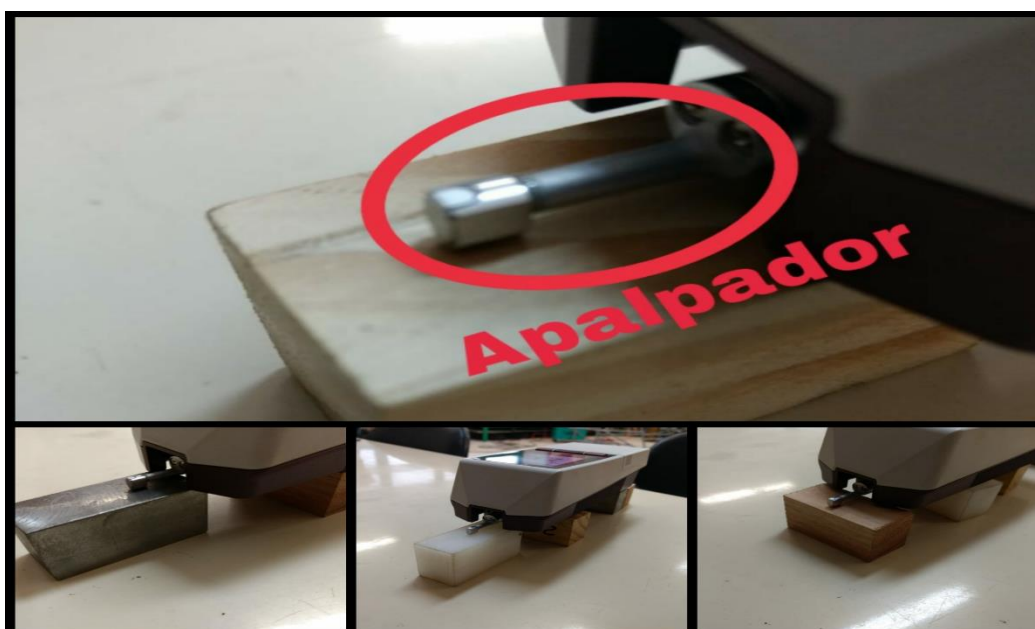
Figura 7 – medição das amostras usando o rugosímetro
