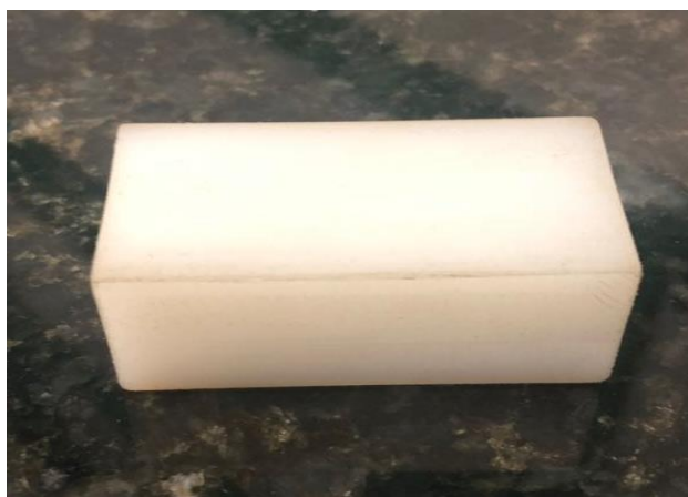
Figura 3: Corpo de prova – Polímero technyl
