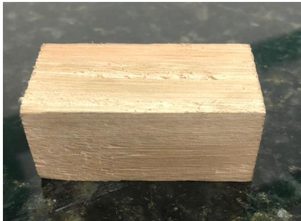
Figura 2: Corpo de prova – Eucalipto citriodora
