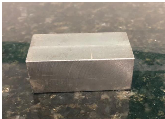
Figura 4: Corpo de prova - Aço 1045
