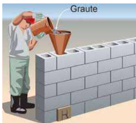
Figura 7. Ilustração do graute nos blocos Site: SOLUÇÕES PARA CIDADES. Fonte: http://solucoesparacidades.com.br/wp-content/uploads/2012/08/PR5_alvenaria_estrutural.pdf , (2018).
