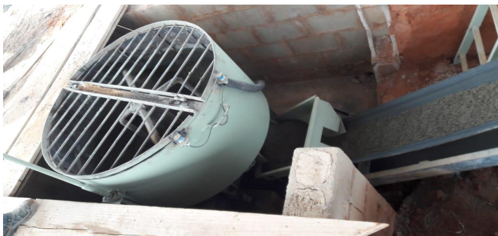
Figura 4: Misturador de concreto. Fonte: Próprio autor, (2018).
