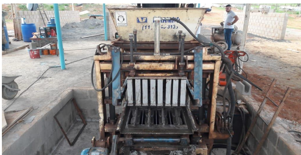
Figura 5: Máquina vibro-prensa. Fonte: Próprio autor, (2018).
