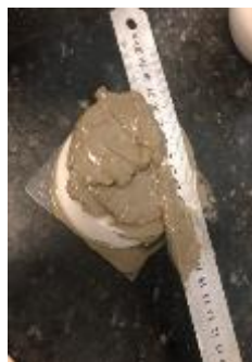
Figura 15: O molde preenchido foi rasado com a régua metálica – Fonte: próprio autor (2018).
