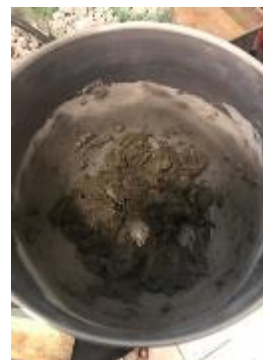
Figura 14: Pasta de cimento pronta ainda na cuba de aço – Fonte: próprio autor (2018).
