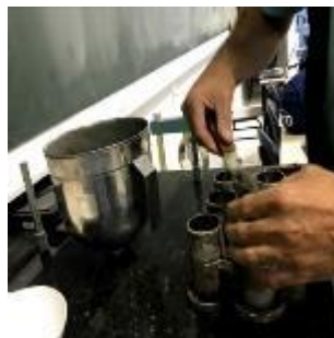
Figura 03: Preenchimentos dos moldes com argamassa preparada - Fonte: próprio autor (2018).
