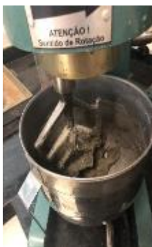
Figura 13: Ligou-se o misturador durante 60 s, em velocidade rápida – Fonte: próprio autor (2018).
