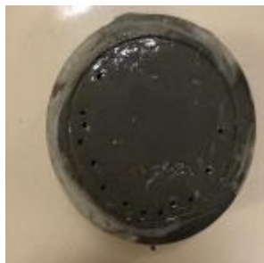
Figura 18: Corpo de prova no molde assim que se deu o início de pega, com as penetrações no lado de base menor do molde – Fonte: próprio autor (2018).
