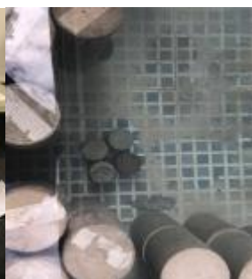
Figura 06: Cura final em água – Fonte: próprio autor (2018).
