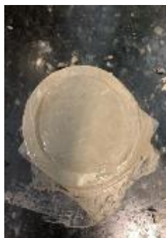
Figura 16: Molde preenchido pronto para ser colocado no aparelho de Vicat – Fonte: próprio autor (2018).
