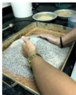
Figura 01: Mistura dos agregados finos, médios e grossos – Fonte: próprio autor (2018).
