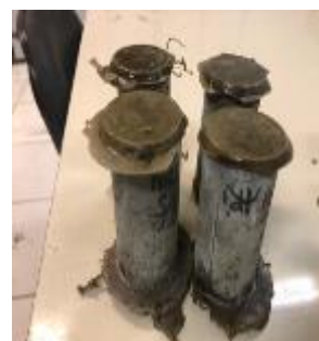
Figura 07: Capeamento dos corpos de prova – Fonte: próprio autor (2018).
