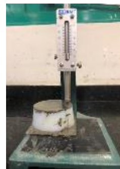
Figura 17: Ajustou-se o indicador na marca zero da escala, quando a agulha tocou a placa-base, fora do molde – Fonte: próprio autor (2018).
