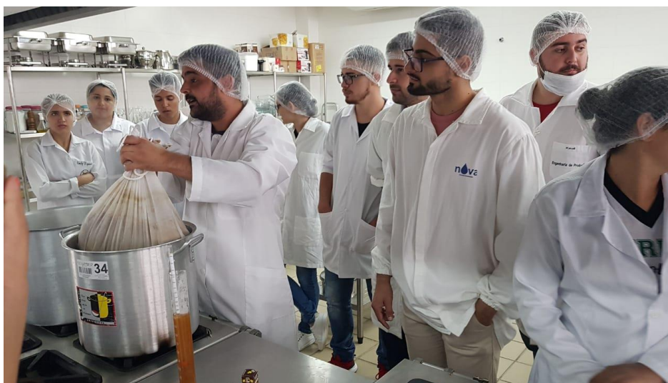
Figura 7 – Etapa de filtração e lavagem do mosto cervejeiro
