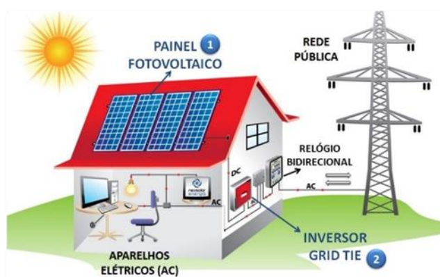
Figura 4 – Esquema de sistemas conectados à rede (ON-GRID ou GRID-TIE)
