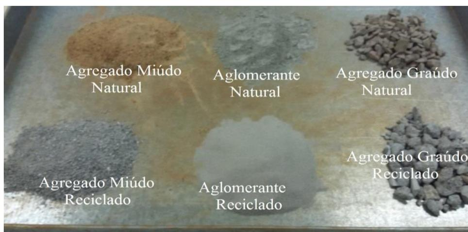
Figura 2 - Agregados naturais e reciclados
