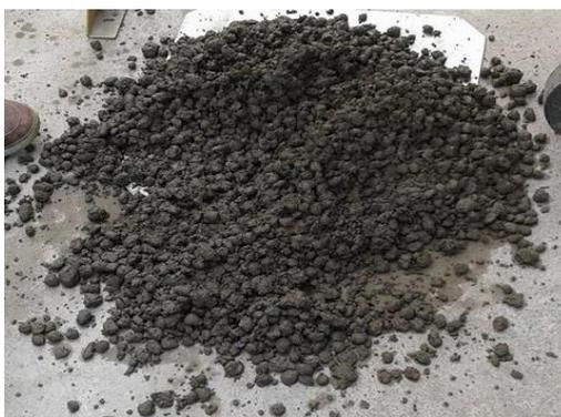
Figura 3 - Concreto com agregado reciclado
