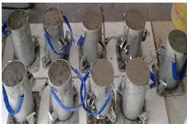
Figura 4 - Corpos-de-prova do traço convencional
