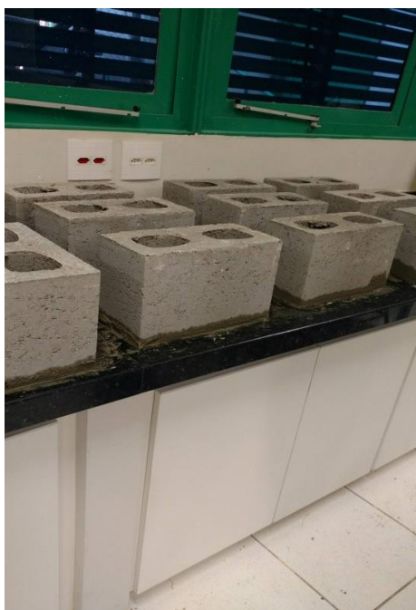
Figura 1 - Blocos em processo de capeamento
